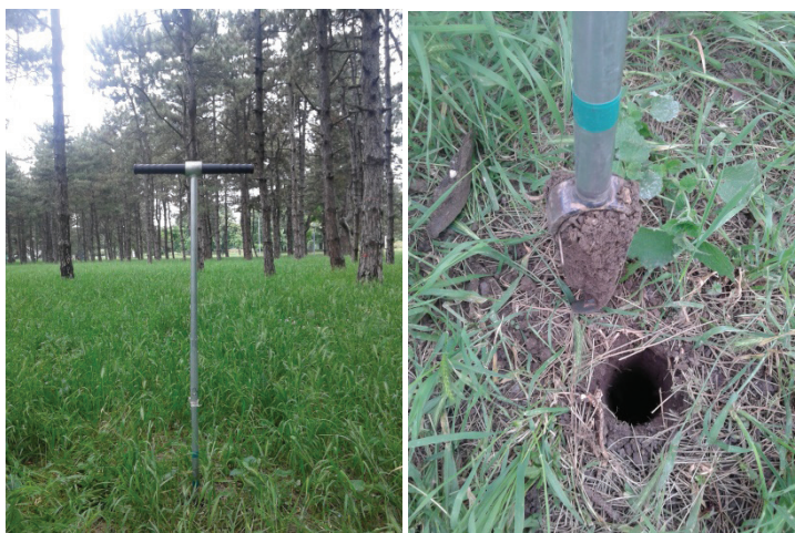
Слика 2. Сонда за узорковање земљишта типа „Eijkelkamp“
