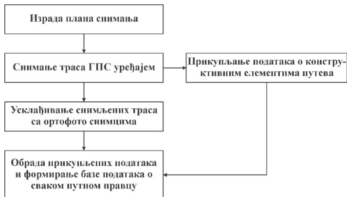
Слика 1. Инвентура шумских путева – фазе рада Figure 1 Forest road inventory – work phases
