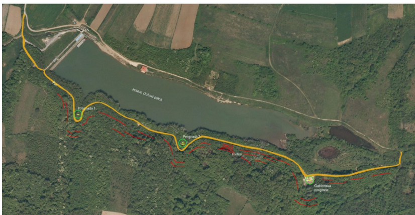
Слика 8. Позиција преграда и плетара у односу на акумулацију Дубоки поток (слика: оригинал)
