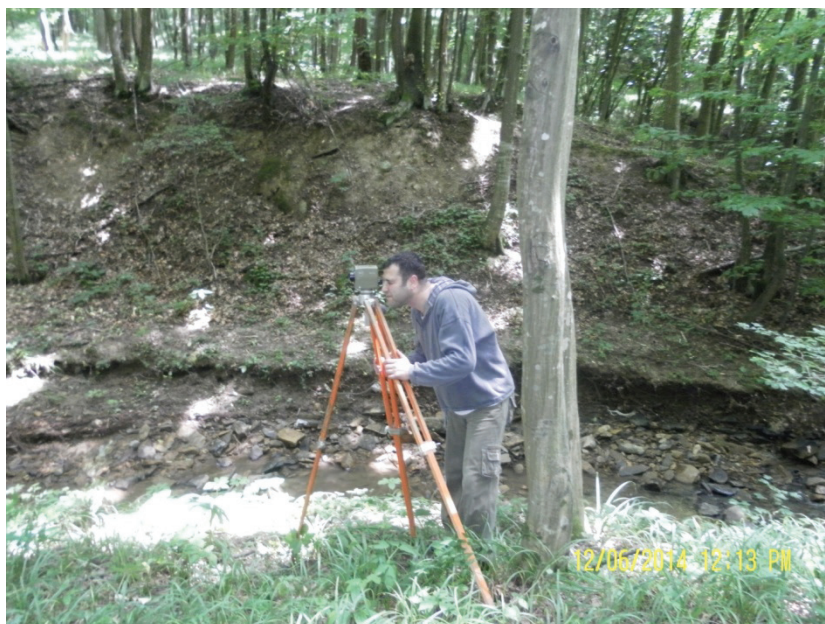
Слика 11. Снимање протицајног профила водотока (фото: В. Ђековић)
