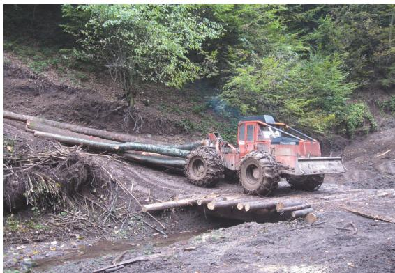
**Слика 3. Трактор на пропусту од дрвета**
