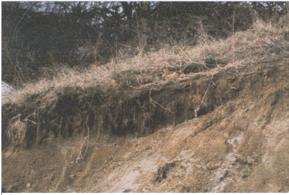
Слика 1. Биолошки „армираног“ прашинасто песковито земљиште Figure 1. Biologically reinforced dusty-sandy soil
